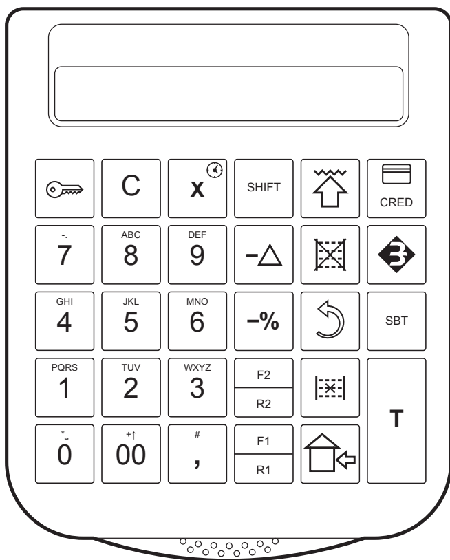
Configurazione tastiera 30 tasti predefinita.
